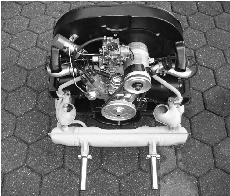
VW Käfer Typ1-Motor mit Serienluftkühlsystem
