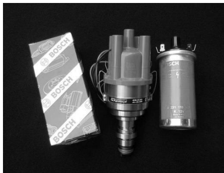
elektron. Zündanlage 123-Igniton
